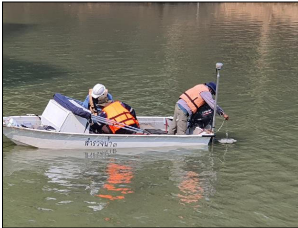
รูปที่ 14 (ต่อ) การตรวจสอบค่าความคลาดเคลื่อนของเครื่องหยั่งน้ำ
