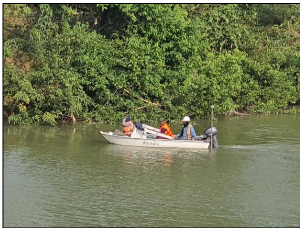
รูปที่ 15 สำรวจระดับพื้นท้องน้ำและการบันทึกข้อมูลด้วยโปรแกรม HYPACK
