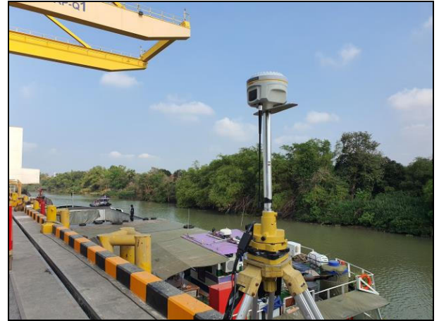
รูปที่ 12 ตั้งสถานี GNSS-RTK BASE STATION
