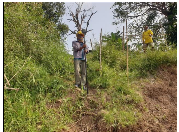
รูปที่ 16 รังวัดค่าระดับขอบตลิ่งด้วยระบบ GNSS-RTK
