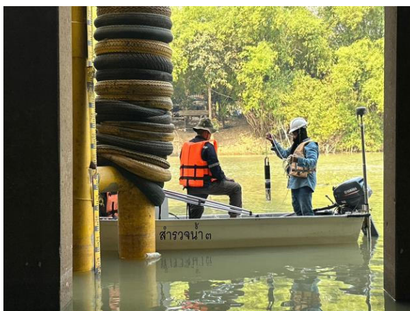
รูปที่ 14 การตรวจสอบค่าความคลาดเคลื่อนของเครื่องหยั่งน้ำ
