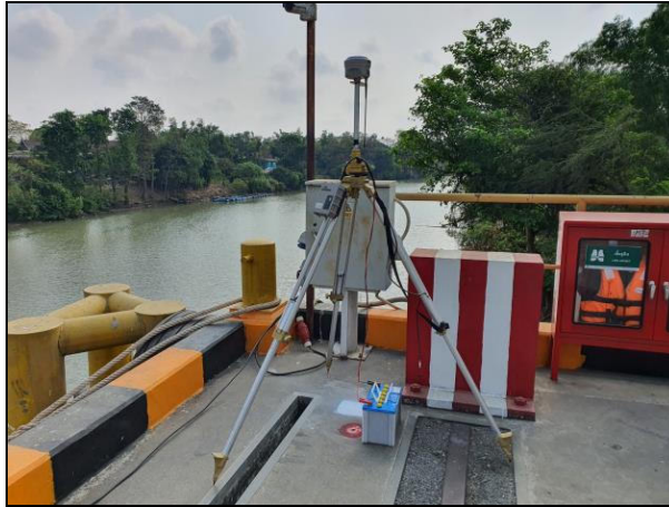
รูปที่ 12 ตั้งสถานี GNSS-RTK BASE STATION
