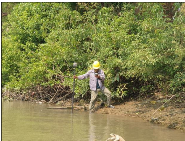
รูปที่ 16 รังวัดค่าระดับขอบตลิ่งด้วยระบบ GNSS-RTK
