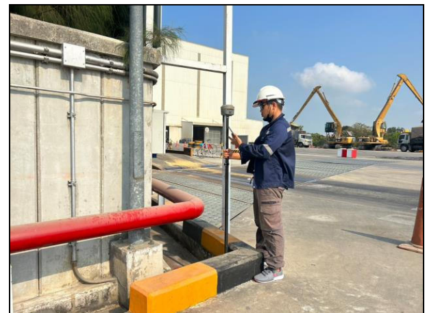
รูปที่ 13 ตรวจสอบค่าความคลาดเคลื่อนของ GNSS-RTK
