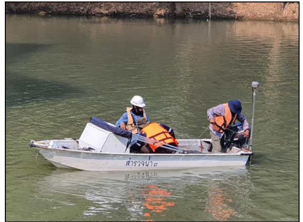
รูปที่ 14 (ต่อ) การตรวจสอบค่าความคลาดเคลื่อนของเครื่องหยั่งน้ำ
