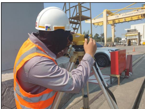
รูปที่ 11 การถ่ายค่าระดับจากหมุดควบคุมโครงการ แบบ Direct Levelling
