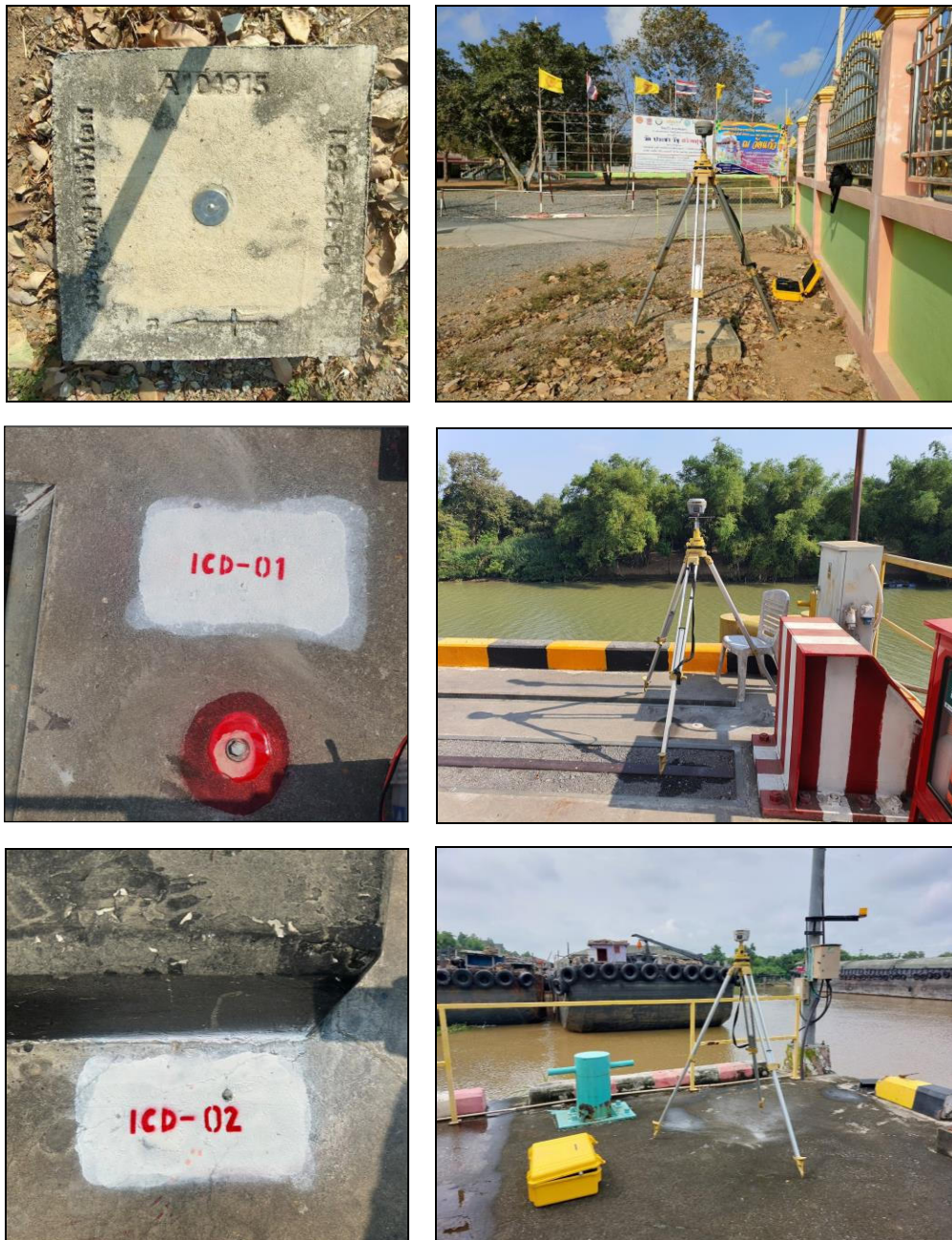
รูปที่ 8 รังวัดค่าพิกัดหมุดควบคุมโครงการด้วยเครื่องรับดาวเทียม GNSS
